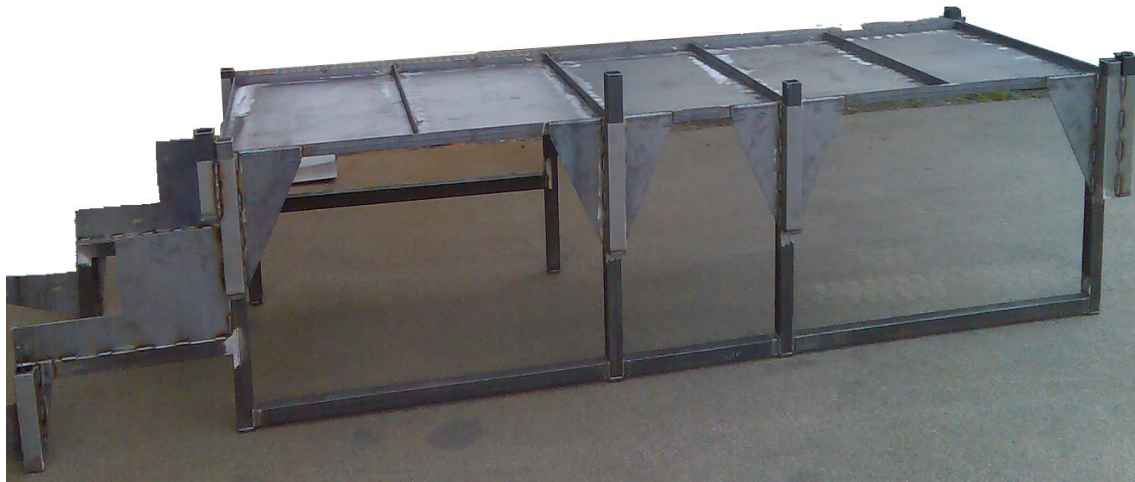
Schweissbaugruppen, hier Bedienpodest
